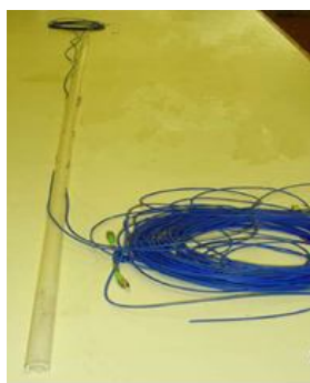
图 4 浅置短距离半柔性探测杆封装方式
